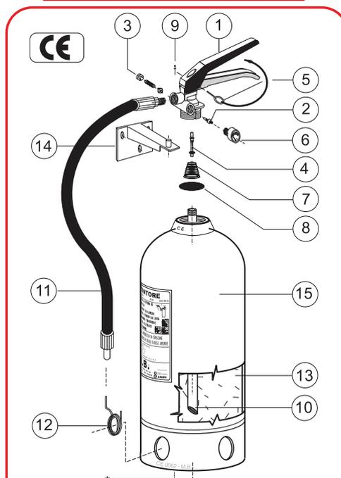
\*\* Marchiatura serbatoio: (Ente di Sorveglianza) CE 1370, produttore serbatoio, decimale anno produzione, (Codice identificativo produttore) 0095, n° matricola serbatoio, (Pressione di collaudo) PT xx Bar.
